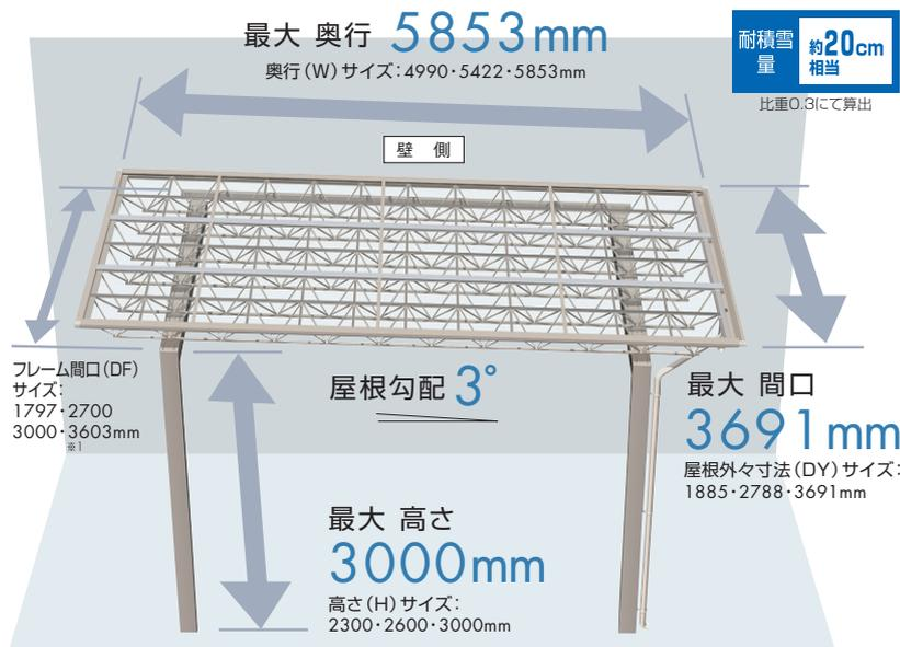
■壁付け (片側支持) 屋根サイズ設定
