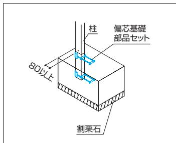
隣地境界にカーポート柱を設置する場合などに基礎の張り出しを小さくできます。施工の自由度が向上します。
