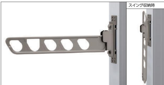
上45°、水平、下25°の3段階操作が可能で、アームのスイング収納により、柱からの張り出し幅を抑えます。
